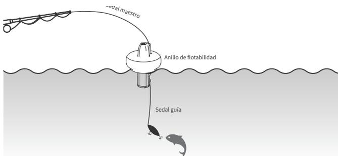
Una vez conectada la cámara, puede llevarse a cabo la pesca de flotabilidad normalmente. Se puede ver la imagen en tiempo real mediante la APLICACIÓN móvil bajo el entorno de pesca de flotabilidad. Sin embargo, en el caso de fuertes vientos y olas que hacen que la cámara se sumerja, la imagen podría congelarse debido a que la señal Wi-Fi se vea interferida.
