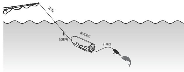
摄像机连接完成后即可正常拖钓，如果您拖钓速度较快的时候，建议在主线上增加配重（如图所示），这样可以确保摄像机在速度较高时不会上浮，配重可根据您预设的拖钓速度进行调节。
