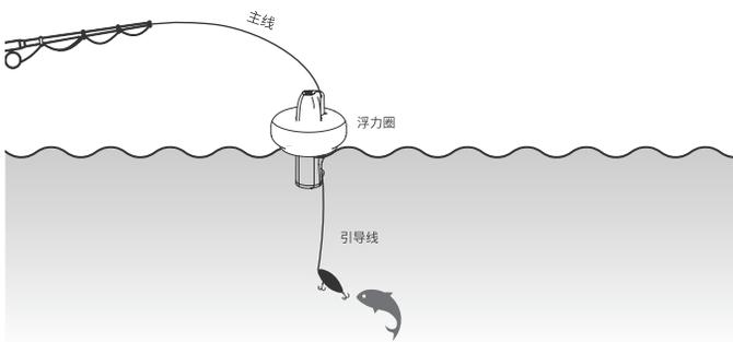
摄像机链接完成后即可正常作钓，浮钓环境下，在Wi-Fi有效范围内，支持手机APP实时观看画面，但在风浪较大导致摄像机被淹没的情况下，Wi-Fi信号可能会收到干扰导致画面卡顿。
