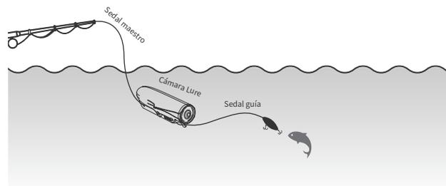
Una vez conectada la cámara, la caña puede lanzarse normalmente, pero hay que tener en cuenta que la distancia de lanzamiento puede ser mayor a medida que aumenta el peso. Al lanzar, se recomienda que use un lanzamiento lateral en lugar del lanzamiento por encima de la cabeza.
