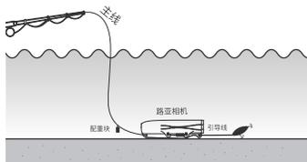
摄像机连接完成后即可正常作钓，建议缓慢的下沉，速度过快造成撞击，摄像机可能会因此损坏。
