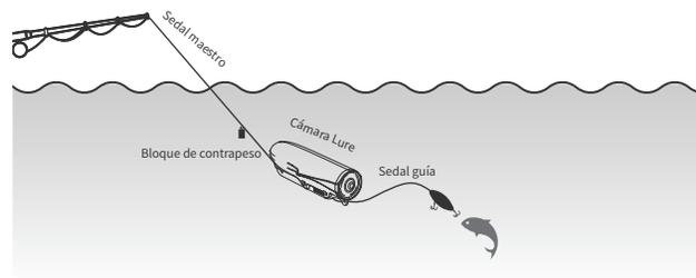
Una vez conectada la cámara, puede llevarse a cabo trolling normalmente, se recomienda agregar un contrapeso en el sedal maestro en el caso de trolling rápido (como se muestra en la figura), esto asegurará que la cámara no flote cuando la velocidad sea alta. El contrapeso se puede ajustar de acuerdo con su velocidad de trolling preestablecida.
