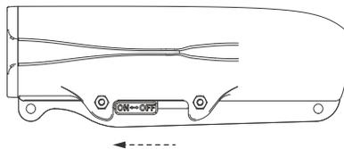
**Apagar:** deslice el interruptor hacia la parte trasera de la cámara para apagarla. En este momento, todas las luces indicadoras se apagarán.
